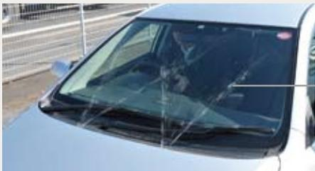
ウインド・ウォッシャ液の噴射の向きおよび高さが適当かを点検します。
