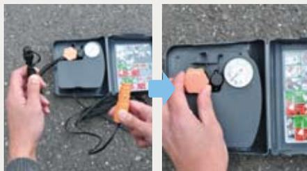
**3** 修理剤ボトルのキャップを外し、注入ホースとの接合箇所に取り付けます。
