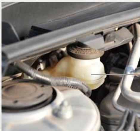
ブレーキ・リザーバ・タンク内の液量が規定の範囲 (MAXとMINの間) にあるかを点検します。
