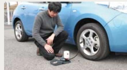
**6** 空気圧が上がったら、コンプレッサーのスイッチをOFFにし、電源プラグを電源ソケットから抜き、注入ホースをタイヤのバルブから抜きます。
