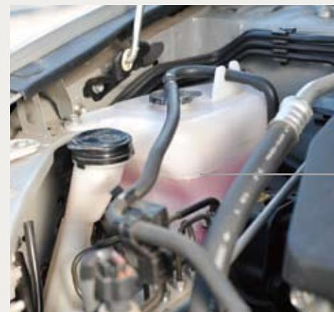
ラジエター・リザーバ・タンク内の冷却水の量が規定の範囲 (FULLとLOWの間) にあるかを点検します。
